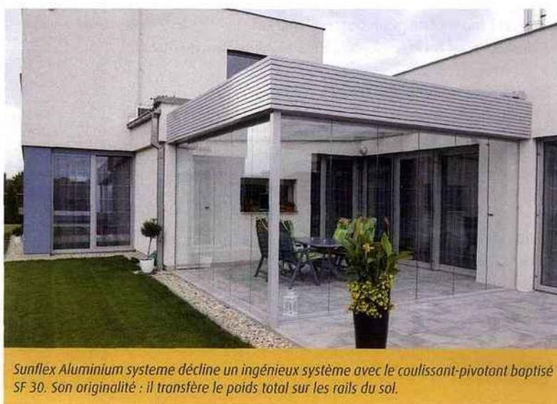
*Sunflex Aluminium système décline un ingénieux système avec le coulissant-pivotant baptisé SF 30. Son originalité : il transfère le poids total sur les rails du sol.*
