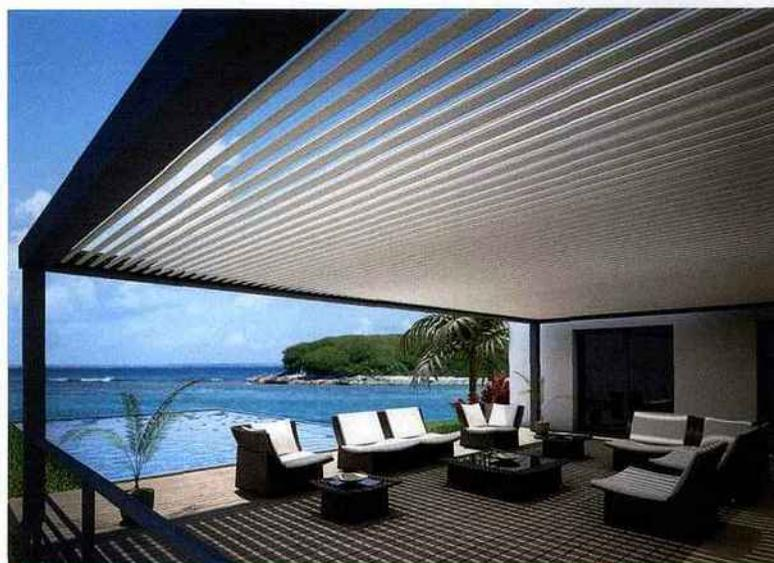
*Prête-à-posser, la pergola bioclimatique Kanopée de Kawneer propose de larges dimensions jusqu'à 7 mètres sans poteau intermédiaire en longueur et jusqu'à 4,5 m en largeur et en hauteur.*
